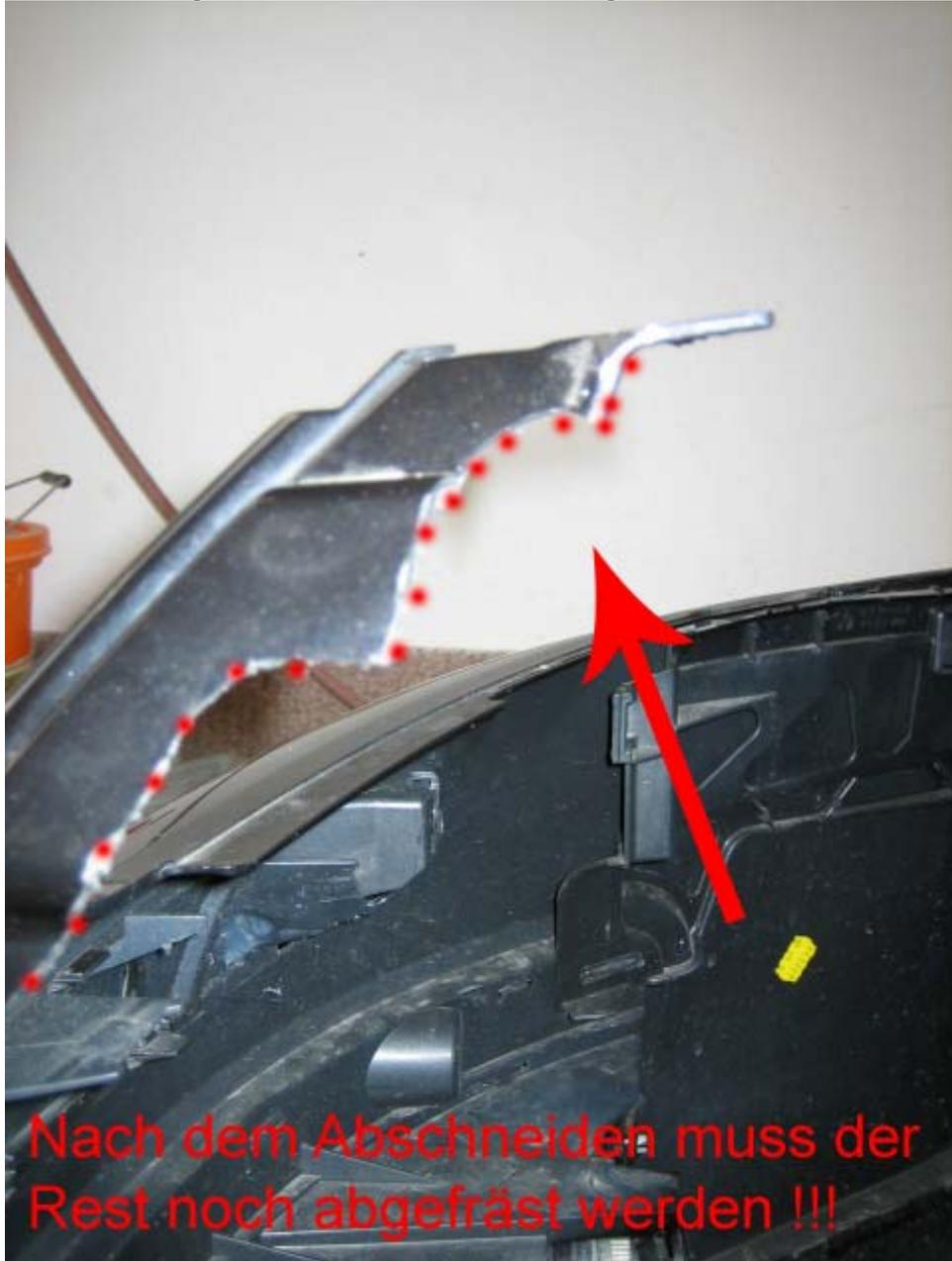
Nach dem Abschneiden muss der Rest noch abgefräst werden !!!
