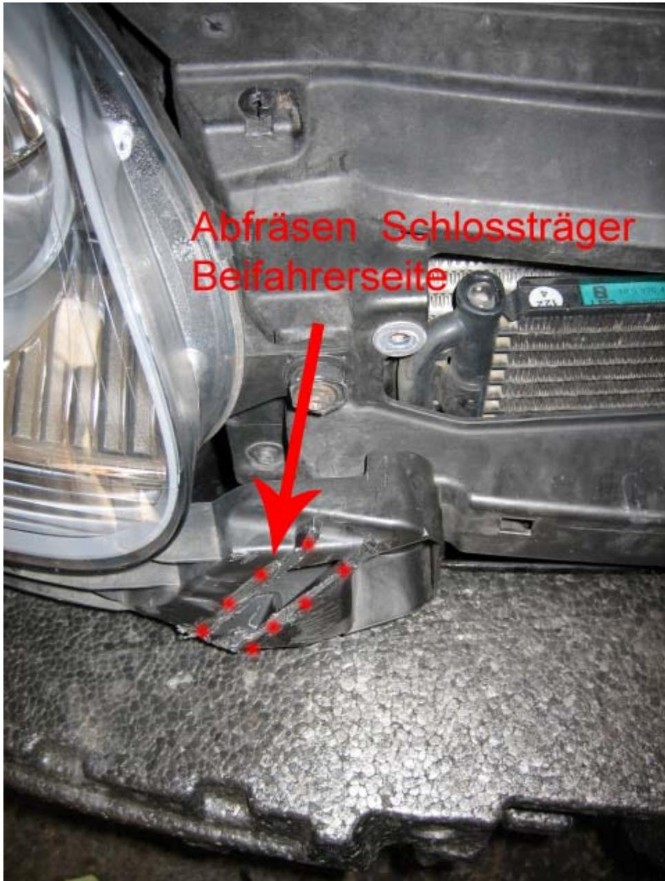
An den rot gepunkteten Stellen wurde der Schlossträger abgefräst!!
